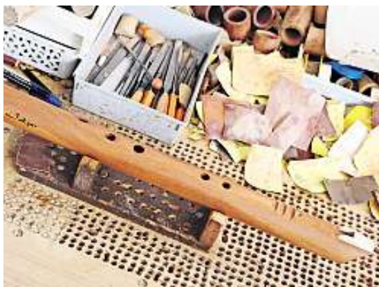
Alf Jetzers Arbeitsplatz mit Stechbeutel, Schleifpapier und Feilen: Werkzeug, das es braucht, um eine Erdklangflöte zu fabrizieren.
